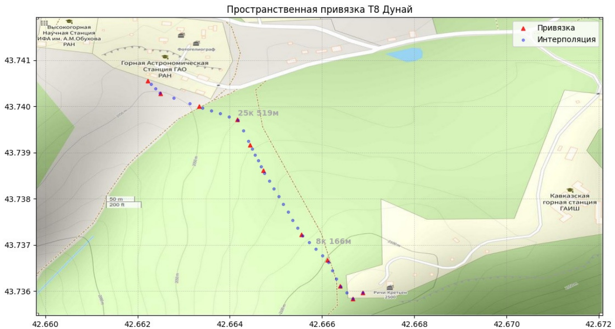
Рис. 1. Пространственная привязка оптоволоконного кабеля на полигоне Кавказской горной обсерватории ГАИШ.
